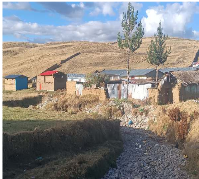
Figura N° 02. Se muestra viviendas de adobe y materiales rústicos, algunas muy cercanas al cauce. Esta situación representa un alto riesgo ante la ocurrencia de lluvias intensas, ya que el caudal podría incrementarse repentinamente y ocasionar desbordes que afectarían directamente a las viviendas e infraestructuras cercanas.
